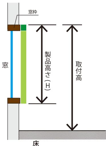
窓枠の外側に取り付ける場合（掃出し窓）
