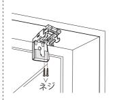
ブラケットと取付けナットで カーテンレールの開口部をは さみ込むように付属のネジで しっかりと固定してください。
